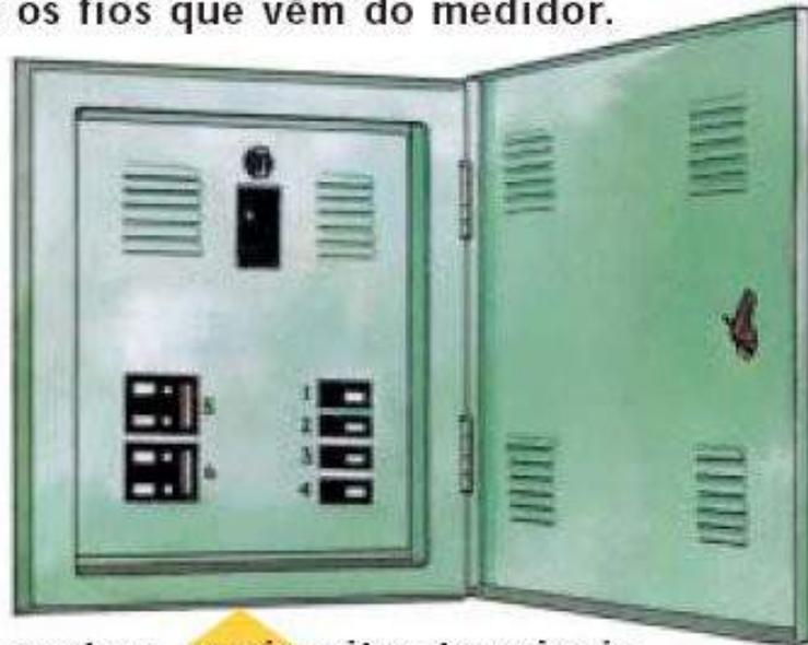
dele é que partem os circuitos terminais que vão alimentar diretamente as lâmpadas, tomadas e aparelhos elétricos.
