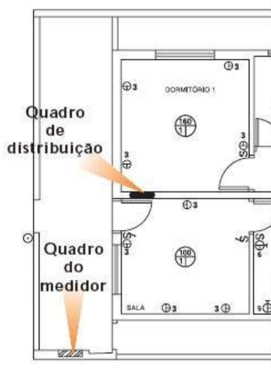
Uma vez determinado o local para o quadro de distribuição, inicia-se o caminhamento partindo dele com um eletroduto em direção ao ponto de luz no teto da sala e daí para os interruptores e tomadas desta dependência. Neste momento, representa-se também o eletroduto que conterà o circuito de distribuição.
