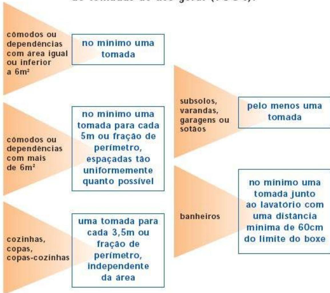
**NOTA:** em diversas aplicações, é recomendável prever uma quantidade de tomadas de uso geral maior do que o mínimo calculado, evitando-se, assim, o emprego de extensões e benjamins (tês) que, além de desperdiçarem energia, podem comprometer a segurança da instalação.
