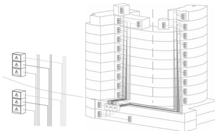
Figura 9 - Solução com alimentadores principais únicos (três tipos de cargas = três linhas de alimentadores principais/barramentos compartilhados por todos os pavimentos).
